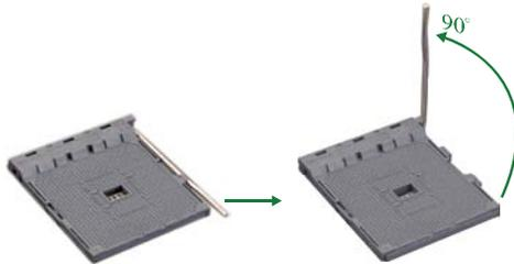
**步骤 3:** 找到插槽上的白色三角，CPU 上的金点应指向此白色三角，CPU 必须按正确的方向放入。
