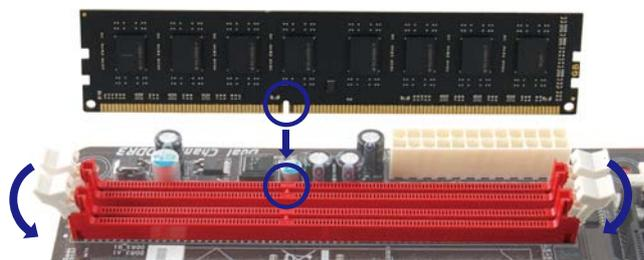
2. 垂直插入 DIMM 并固定好，直到固定夹跳回原位，DIMM 就位。
