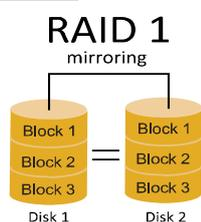
每次读写实际上是在磁盘阵列系统中(RAID 1), 通过 2 个磁盘驱动器并行完成的。RAID 1 或镜像模式能够自动对数据进行备份,通过将一块硬盘中的数据完整复制到另外一块硬盘实现数据的冗余。假如由于硬盘的损坏,导致驱动失败,或是容量过大, RAID1 可以提供一个数据备份。RAID 技术可以应用于高效方案,或者可以作为自动备份形式,代替冗长的,高价的且不稳定的备份形式。
