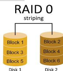
创建带区集，在同一时间内向多块磁盘写入数据，通过把数据分成多个数据块（Block）并行写入/读出多个磁盘以提高访问磁盘的速度分散到所有的硬盘中同时进行读写，在整个磁盘阵列建立过程中，以系统环境为基础，指数的大小决定了每块磁盘的容量。此技术可减少整个磁盘的存取时间和提供高速带宽。
