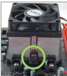
**步骤 2:** 将另一边的固定夹向下压，扣住支架上的塑胶凸耳。然后固定，使风扇和散热片扣住支架底座。
