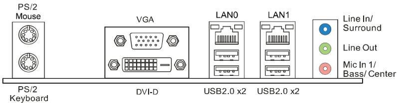
**注意 1:** 带集成显卡的 AMD 系列处理器才支持 HDMI、DVI-D 和 VGA 输出端口。
