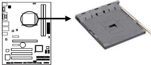
**步骤 2:** 将固定拉杆从插槽处水平拉起至 90 度。
