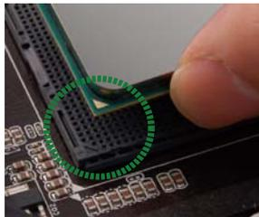
**步骤 4:** 固定 CPU，将拉杆闭合。
