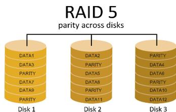
RAID 5 数据块和奇偶块信息跨 3 块或更多块驱动器。奇偶校验数据分散分布在磁盘阵列的全部硬盘。容错的维护是由确保数据块传输奇偶块信息实现的，此信息被放置在不同于那些自身可以储存信息的驱动盘里。
