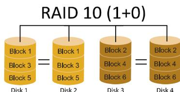
RAID 10 模式是对 RAID 0/ RAID 1 两种不同模式的结合，可以同时支持带区集和镜像，这样既可以提升速度又可以加强数据的安全性。
