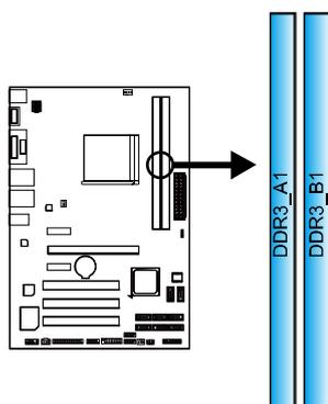
1. 向外推开固定夹，打开 DIMM 插槽。将 DIMM 按顺序放在插槽上，DIMM 上的切口须与插槽凹口匹配。
